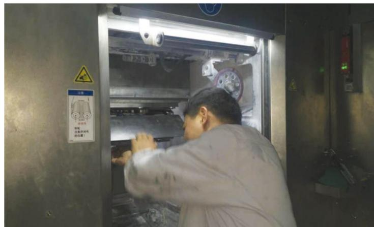
10月16日在厂方工程师的指导下，支持组全体成员把摇摆机构顺利拆下，进行解剖部件、分析成因。得出解决方案是更换摇摆机构或机构部件二副弧度导轨。
